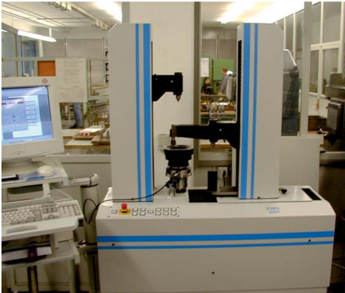
Innenverzahnungsprüfung mit Aufspannfehlerkompensation (SPN, Nördlingen)
